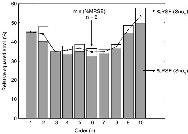
Fig. 7. Estimation error spectrum.
